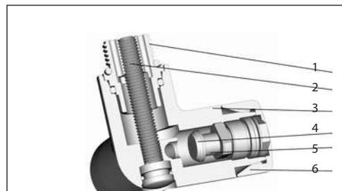
Устройство клапана RLV-X
