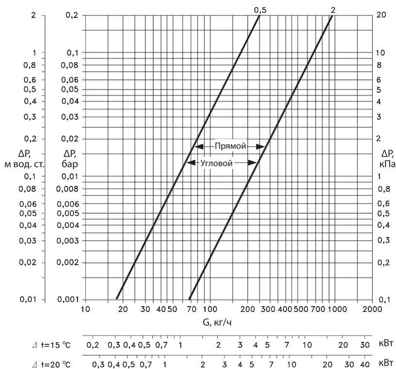
Характеристики приведены для клапанов в комбинации с термостатическими элементами серии RTR 7000
