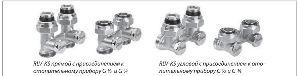
Клапан запорно-присоединительный RLV-KS предназначен для подключения к двухтрубным горизонтальным системам отопления отопительных приборов с нижними присоединительными штуцерами при их межосевом расстоянии 50 мм. Клапан RLV-KS не подходит для присоединения к нему спускного крана.
