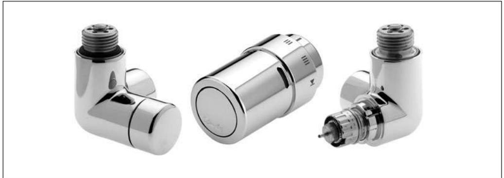
Терморегулирующий комплект X-tra™ специально разработан для полотенцесушителей. Он состоит из клапана терморегулятора, термостатического элемента и запорного клапана с дренажной функцией. Инновационное самоуплотняющееся присоединение клапанов к радиатору осуществляется с помощью резьбы 1/2".
