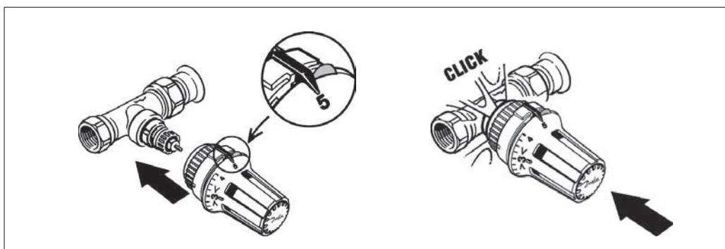
Конструкция корпуса клапана радиаторного терморегулятора предусматривает его монтаж на входном патрубке отопительного прибора системы отопления. При этом стрелка на корпусе клапана должна совпадать с направлением движения теплоносителя. В случае применения термозлемента со встроенным датчиком клапан необходимо устанавливать так, чтобы его шток был в горизонтальном положении.
