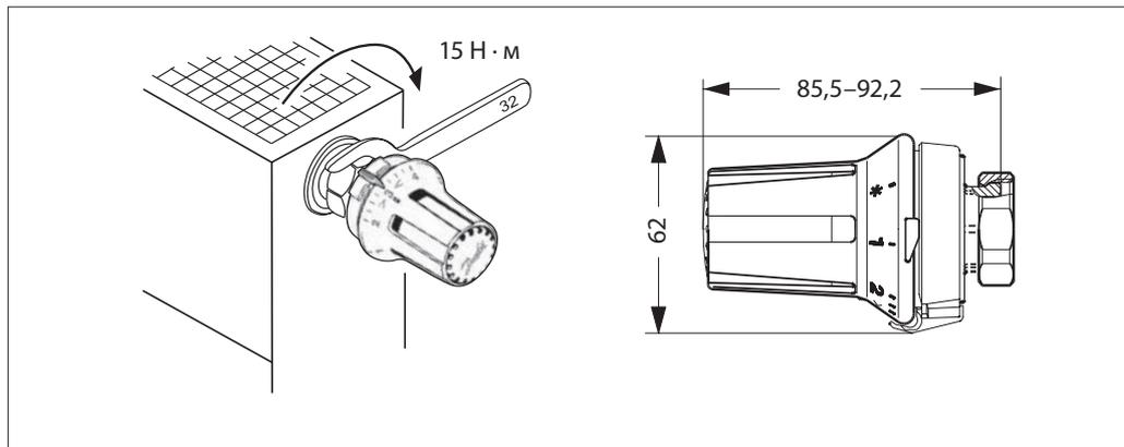
Монтаж термостатического элемента серии RTRW-K на клапан терморегулятора производится легко и быстро с помощью соединительной гайки М 30 x 1,5.
