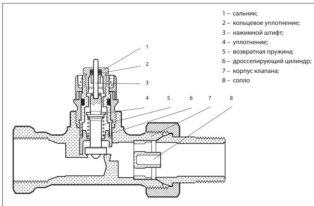
Радиаторный терморегулятор состоит из двух частей: универсального термостатического элемента серии RTR и регулирующего клапана с предварительной настройкой RTR-N. Термостатический элемент и регулирующий клапан заказываются отдельно.
