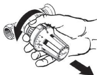
**Защита от несанкционированного демонтажа термоэлемента**
