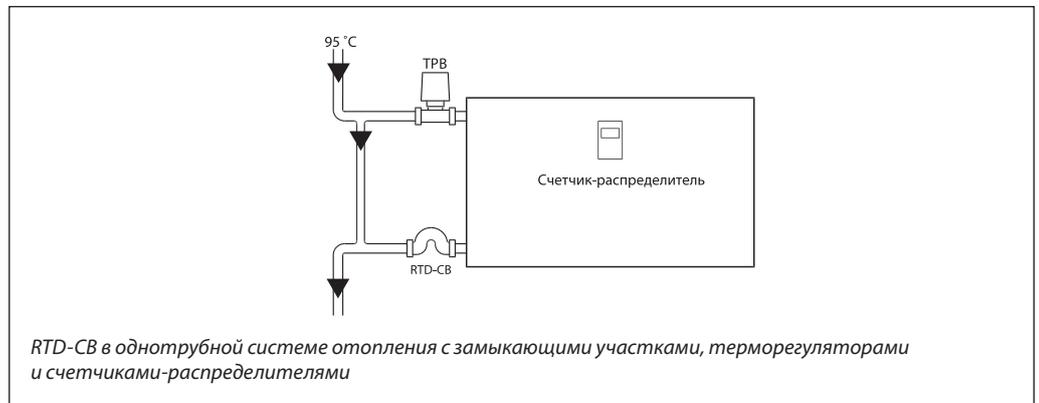
RTD-CB в однотрубной системе отопления с замыкающими участками, терморегуляторами и счетчиками-распределителями
