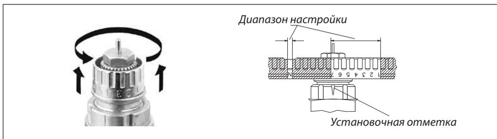
Клапан RA-N позволяет легко и просто выполнить предварительную настройку без использования специального инструмента. Для этого следует произвести следующие операции:
