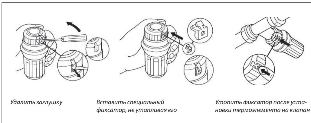
Фиксатор можно удалить с помощью ключа с резьбой (кодированный номер **013G1236**), для этого необходимо:
