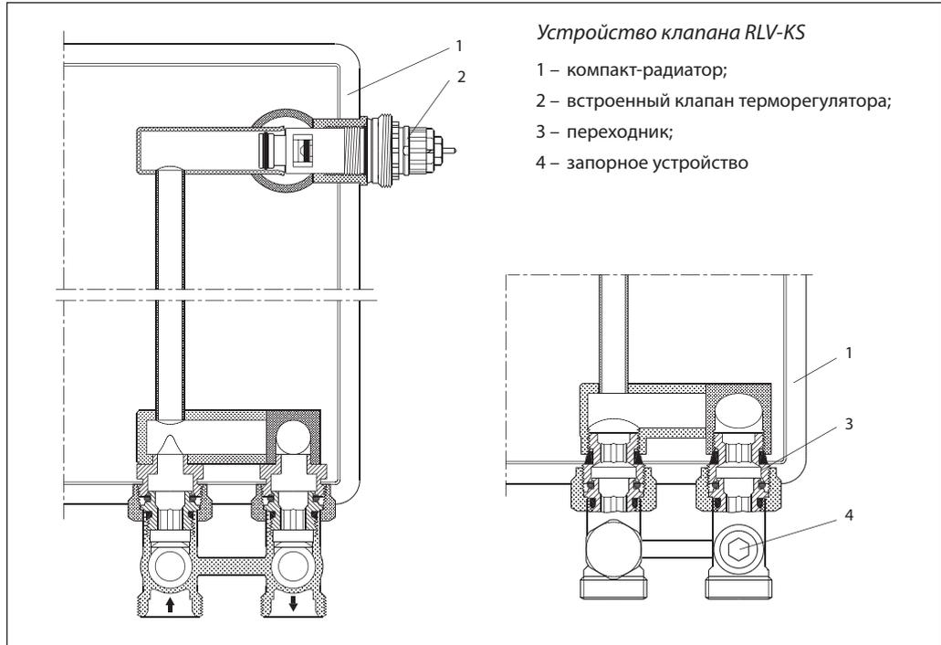
*Устройство клапана RLV-KS*
