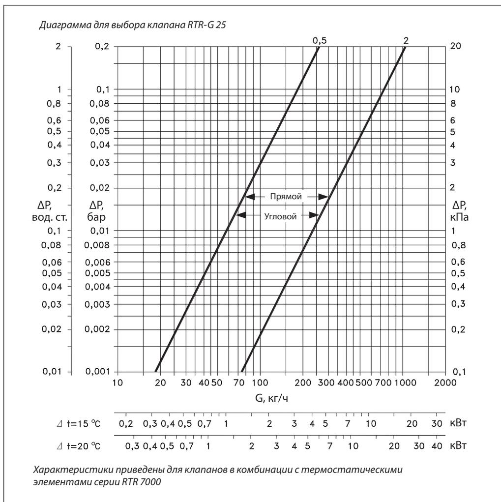
**Пример выбора регулирующего клапана RTR-G**
