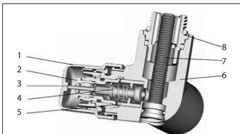
Устройство клапана RA-URX
